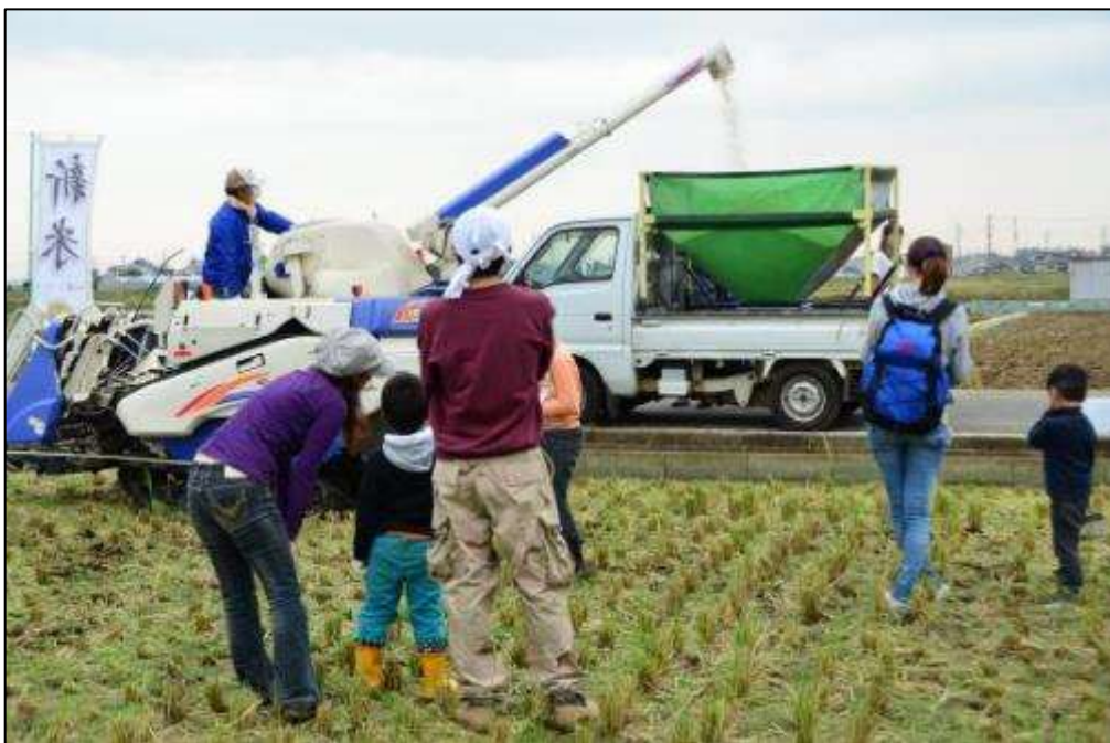
脱穀されたモミ米が、コンバインからホッパーを付けた、モミ米運搬車に移されます。
